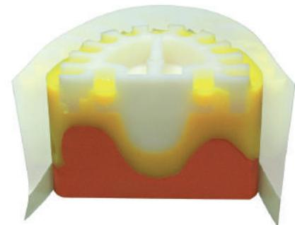
Querschnitt durch eine küvettenlose Dublierung
