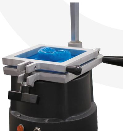
Обожмите пластину по модели. Если использовать ламинаты позиция фиксирующего устройства формера примерно 3 мм. от резового края небной стороны.
