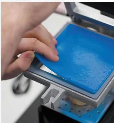
Поместите пластину в рамке и нагревайте до провисания ее примерно на 1 см. Сбрызните модель силиконом и поместите на платформу вакуумформера.
