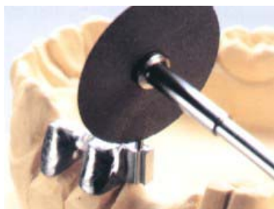
10 Если укорачивать матрицу, то углубите шлиц в головке активирующего винта отрезным диском 0,3мм.
