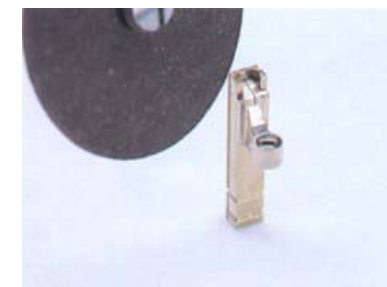
27 Подходящим вращающимся шлифовальным инструментом матрицы пришлифовываются до высоты матриц.
